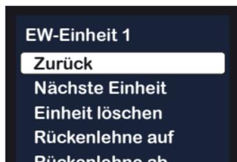
Das Anlernen der Funktionen erfolgt nacheinander. Dazu werden die auf der EW-Einheit entsprechenden 8 Funktionen betätigt, die im Display erscheinen: Rückenlehne auf, Rückenlehne ab, Liegefläche auf, Liegefläche ab, Fußlehne auf, Fußlehne ab, Fußtieflage auf, Fußtieflage ab.
